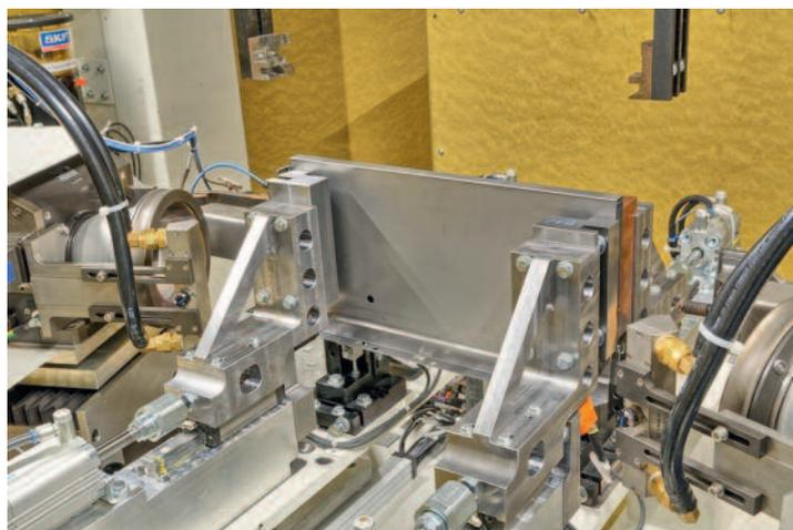
Positioniertes Werkstück: Schweißung mit zwei Scheibenlaserköpfen.
