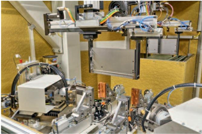
Durchtakten der Werkstücke mit einem „Portal-Shuttle“ – die Laserstation ist ausgerüstet mit einer Laserschutzkabine und ist Bestandteil einer komplexen Transfer-Fertigungslinie.
