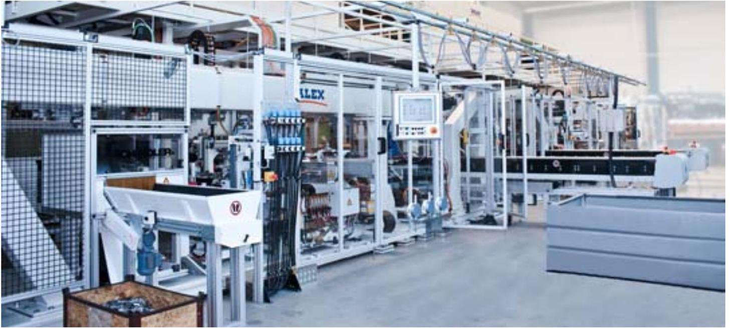
Vollautomatisierte Gesamtlösungen inklusive Teilelogistik, IO/NIO-Ausschleusung, spiegelbildliche Ausführung für die gleichzeitige Fertigung linker und rechter Teile, raumsparende Schaltschrankanordnung auf einer über der Anlage angeordneten Bühne.
