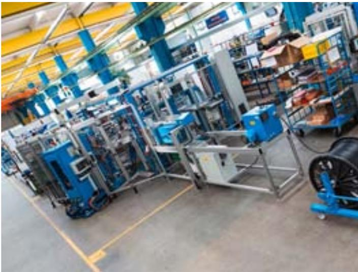
Rundtaktmontageautomat für die Fertigung von Litzenkabeln inklusive Haspeleinheit mit Tänzersteuerung, Mess- und Ablängeinheit für das Kabel, ausgelegt für unterschiedlichste Kabellängen und Kabeldurchmesser.
