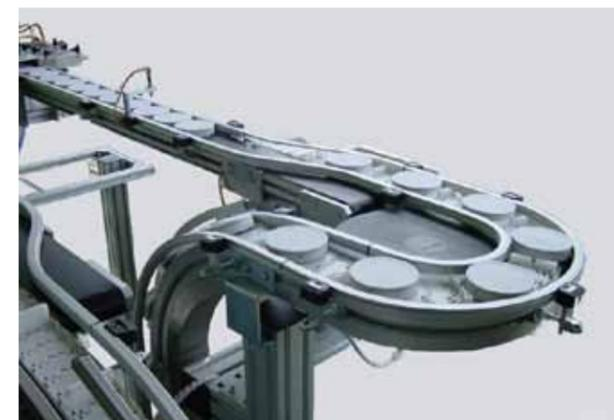
DALEX Ketten-, Band- und Rollenförderer werden in verschiedenen Lastklassen für den jeweiligen Anwendungsfall konfiguriert.
