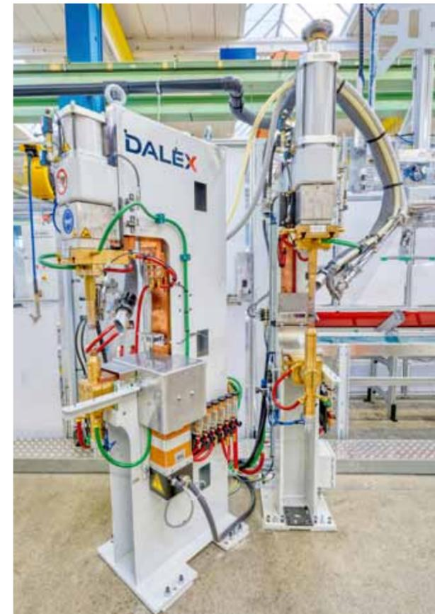
Roboterschweißzelle mit 2 St. DALEX-C-Schweißmodulen, die mit jeweils einer DALEX-Zuführeinrichtung ausgestattet sind.
