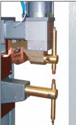
Parallel geführtes Elektroden-Kraftsystem zur Einbringung von Kräften bis max 600 daN.
