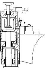
Der Vorhubkolben ist schwimmend angeordnet. Über eine Zustellspindel wird der Vorhub stufenlos eingestellt.
