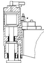
Der Vorhubkolben ist schwimmend angeordnet und erbringt konstanten Vorhub.
