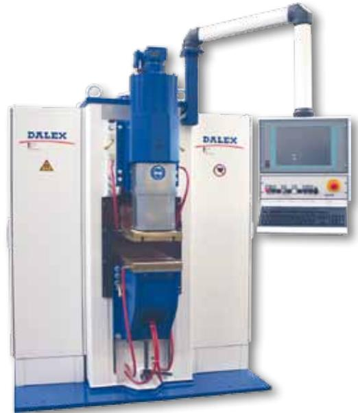
DALEX-Kondensatorentladungs-Buckelschweißmaschine Typ PMS 37-6 KE
