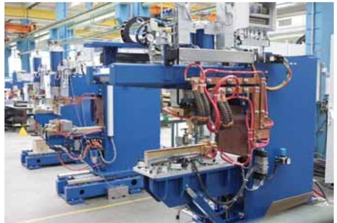
Komplexe Schweißaufgaben werden mit der Modifizierung von DALEX-Serienmaschinen aus der PMS-Baureihe nach dem Baukastensystem schnell und kostengünstig gelöst. Ergänzt durch die auf den Anwendungsfall zugeschnittenen Spezial-Werkzeuge werden die Voraussetzungen für reproduzierbare Schweißergebnisse geschaffen.
