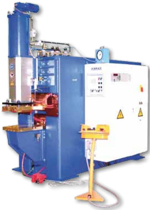
DALEX-Dreiphasen-Gleichstrom-Buckelschweißmaschine Typ PMS 38-6 G3
