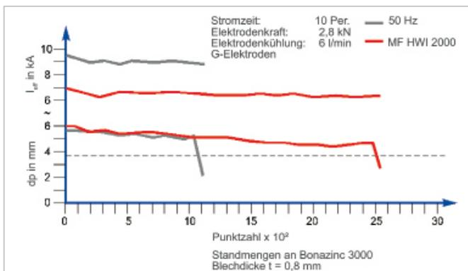
ELEKTRODENSTANDZEIT MF GLEICHSTROM/WECHSELSTROM
