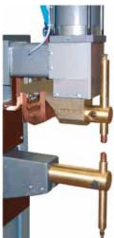
Ausladung stufenlos verstellbar sowie höhenverstellbarer Armabstand durch 180° Drehung des unteren Auslegers
