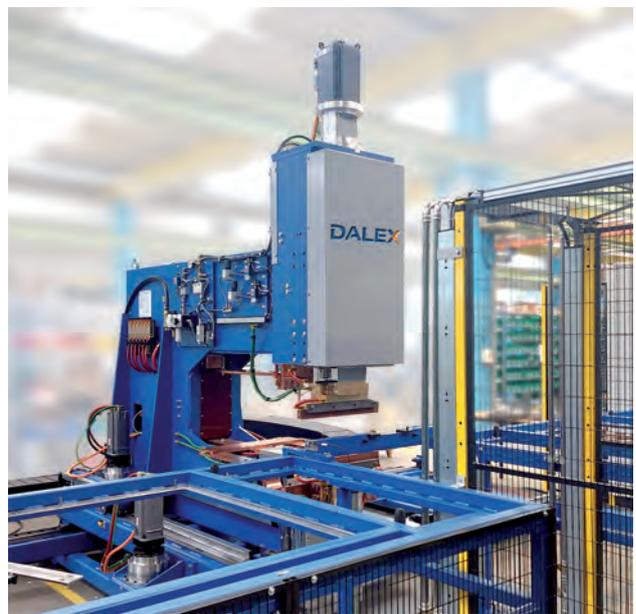
**DALEX-Punktschweißmaschine Typ PMS 12-6 MF in Mittelfrequenztechnik, ausgestattet mit einem EPS-Antrieb 2000 daN**
