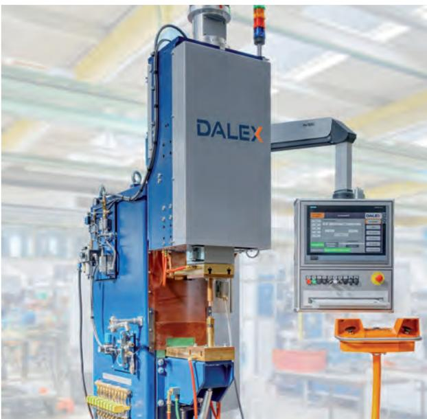
DALEX-Buckelschweißmaschine Typ PMS 36-6 MF
