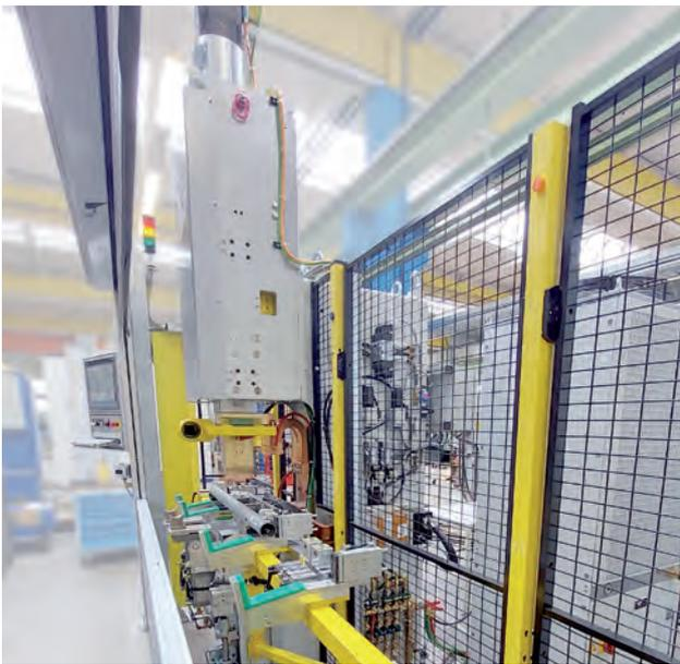
**DALEX-C-Modul als Buckelschweißmaschine in Mittelfrequenztechnik, ausgestattet mit einem EPS-Antrieb 1750 daN**
