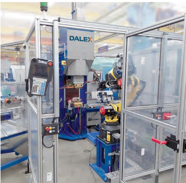
**DALEX-Buckelschweißmaschine Typ PMS 37-6 MF in Mittelfrequenztechnik, ausgestattet mit einem EPS-Antrieb 4200 daN**
