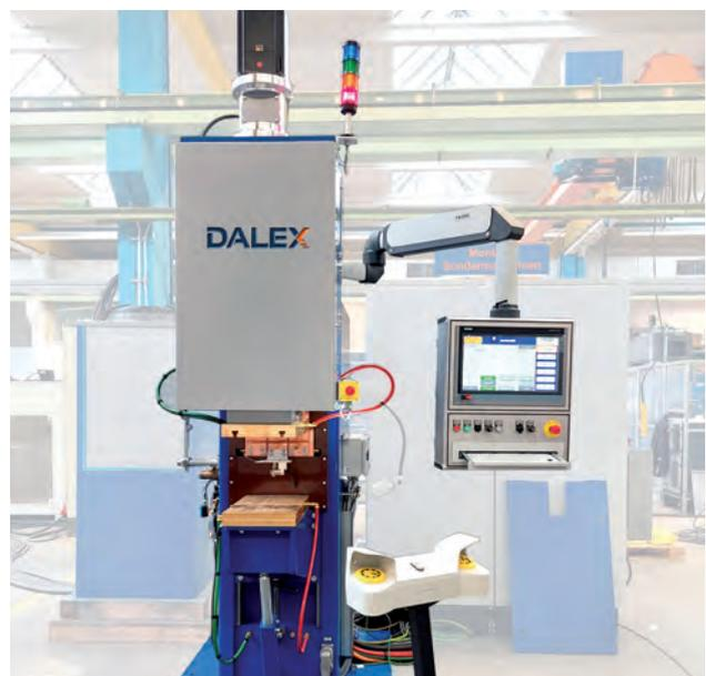
**DALEX-Buckelschweißmaschine Typ PMS 37-6 MF in Mittelfrequenztechnik, ausgestattet mit einem EPS-Antrieb 4200 daN**
