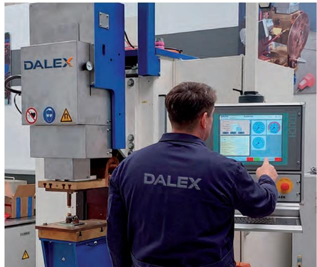
Komfortable Bedienung: Nach der Einstellung der Schweißkraft legt die Maschinensteuerung automatisch anhand von hinterlegten Kennliniensätzen den Schweißdruck fest und ermittelt die erforderliche Federkompression.
