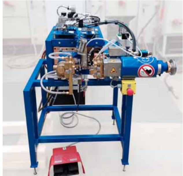
Tisch-Buckelschweißmaschine in Sonderausführung für das Lötén
