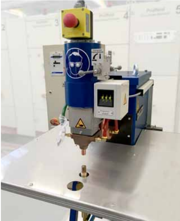
DALEX-Mittelfrequenz-Tisch-Punktschweißmaschine Typ PMS 10-6 MF mit 90 kVA
