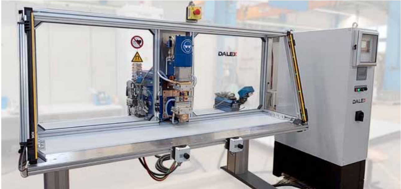
Tisch-Punktschweißmaschine Typ PMS 10-6 T in Sonderausführung
