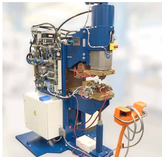
DALEX-Buckelschweißmaschine Typ PMS 36-6 MF in Mittelfrequenz-Technik mit 700 kVA
