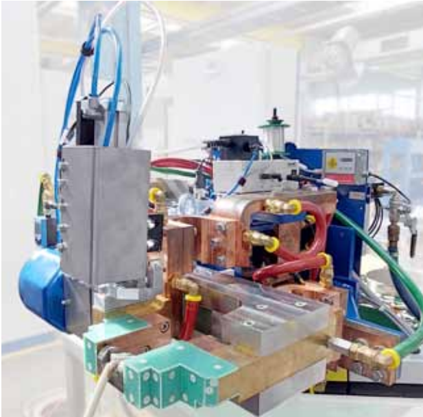
Ausgleichzange in Sonderausführung waagrecht angeordnet für das Lötén
