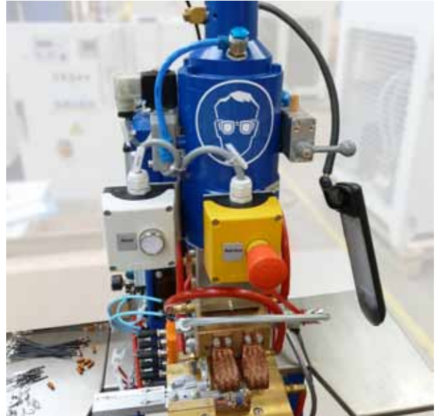
DALEX-Mittelfrequenz-Tisch-Punktschweißmaschine Typ PMS 10-6 MF mit 90 kVA
