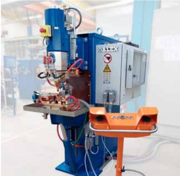
DALEX-Mittelfrequenz-Buckelschweißmaschine Typ PMS 14-6 MF mit 2 x 250 kVA
