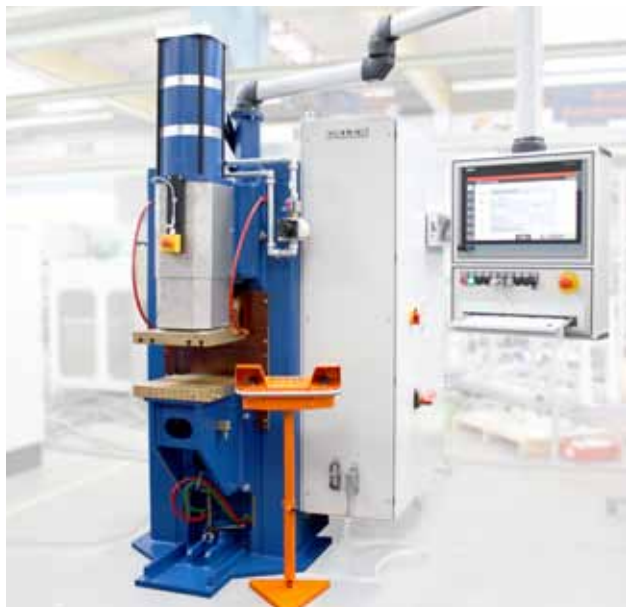
DALEX-Buckelschweißmaschine Typ PMS 38-6 MF in Mittelfrequenztechnik mit 4 x 180 kVA
