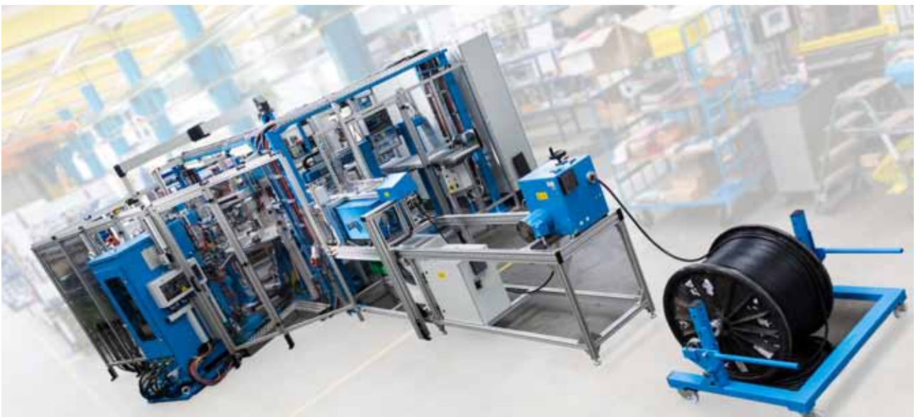
Vollautomatische 16-Stationen-Drehtischanlage für die Kabelkonfektionierung
