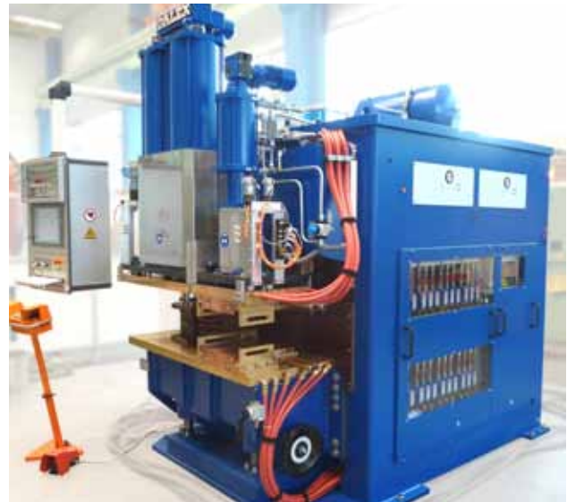
DALEX Dreiphasen-Gleichstrom-Buckelschweißmaschine Typ PMS 38-6 G3 zum Buckelschweißen von Cu-Bändern
