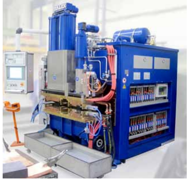
DALEX-Dreiphasen-Gleichstrom-Buckelschweißmaschine Typ PMS 38-6 G3 mit 1200 (6 x 200) kVA
