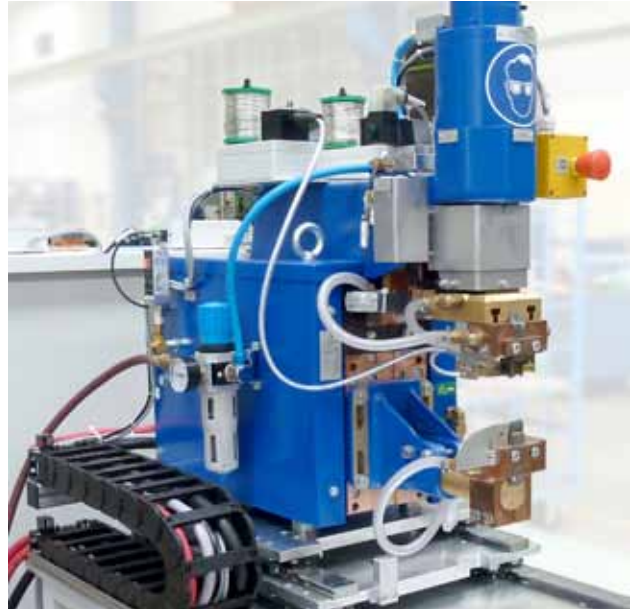
Tisch-Buckelschweißmaschine in Sonderausführung mit Linearschlitten zum Hartlöten
