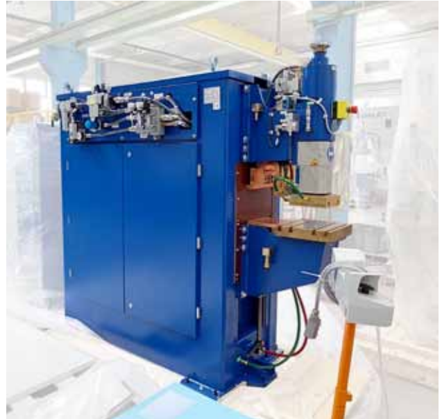
DALEX-Dreiphasen-Gleichstrom-Buckelschweißmaschine Typ PMS 36-6 G3 mit 600 (3 x 200 kVA)
