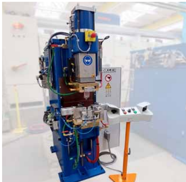
DALEX-Buckelschweißmaschine Typ PMS 36-6 MF in Mittelfrequenz-Technik 2 x 180 kVA
